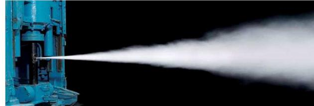
写真-1 従来工法のモニター
