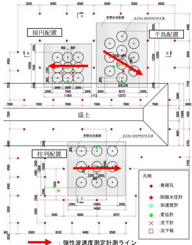
図-1 GEOPASTA 工法配置および計測器配置平面図
