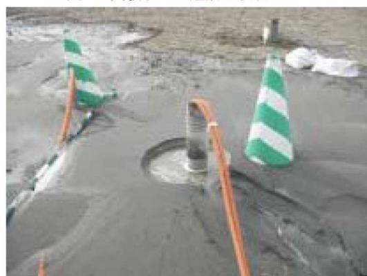
写真1 実験後の噴砂の様子
