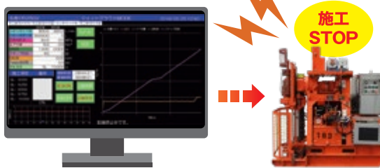
自動で施工エラーを判定し、施工機を自動停止させます。
