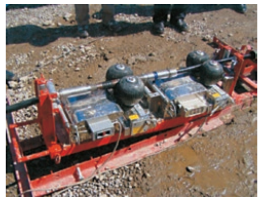
水平エアースパーキング用のエア注入内管と挿入装置
