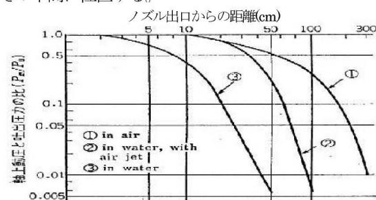
図-2 水中および空気中における水噴流の減衰曲線
